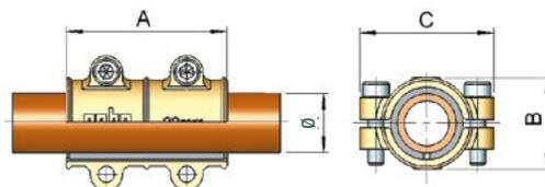
PARA TUBOS DE COBRE ABRAZADERA CON TOMA TIPO RB
