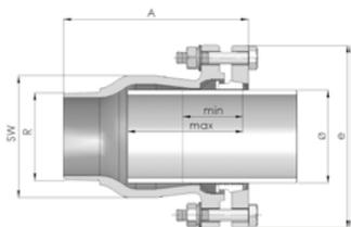
RACORES DE COMPRESIÓN DE FUNDICIÓN MALEABLE CON ROSCA MACHO PARA TUBOS DE PE CON CASQUILLO
