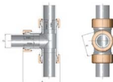
Para la instalación con PE es absolutamente necesario el uso de casquillos GEB0
