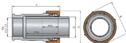
Para la instalación con PE es absolutamente necesario el uso de casquillos GEBO
