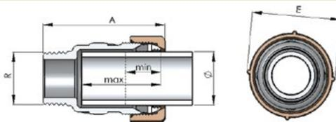
Para la instalación con PE es absolutamente necesario el uso de casquillos GEB0
