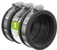
Adaptador externo para conectar dos sistemas de tuberías con las mismas dimensiones (DN), así como para diferentes materiales. Con labios de sellado que reducen el ruido. Apto para instalación horizontal o vertical. Adecuado para instalación empotrada y en suelo con tuberías enterradas. Material resistente a los rayos UV y a las inclemencias climáticas.
