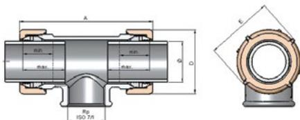
Para la instalación con PE es absolutamente necesario el uso de casquillos GEBO
