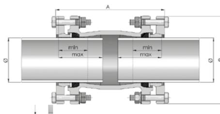
RACORES DE COMPRESIÓN DE SUJECIÓN POR AMBOS LADOS PARA TUBOS DE PE CON CASQUILLO
