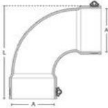
Codo de 90° para conectar dos sistemas de tuberías con las mismas dimensiones de tubo (DN), así como para diferentes materiales. Apto para instalación horizontal o vertical. Adecuado para instalaciones empotradas en pared, y en tuberías enterradas en suelo. El material es resistente a los rayos UV y a las inclemencias climáticas. Reduce el ruido.
