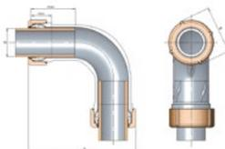
Para la instalación con PE es absolutamente necesario el uso de casquillos GEBU
