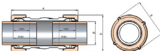
Para la instalación con PE es absolutamente necesario el uso de casquillos GEB0
