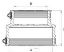
Adaptador externo para reducir dos sistemas de tuberías con diferentes diámetros exteriores, así como diferentes materiales o estructuras superficiales. Adecuado para instalación horizontal o vertical. Apto para instalaciones empotradas en pared, y en tuberías enterradas en suelo. Material resistente a los rayos UV y a las inclemencias del climáticas.
